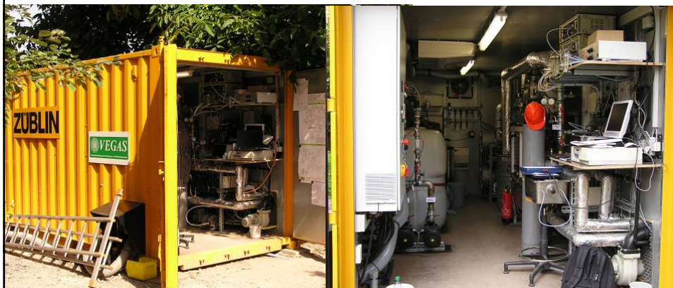
Pompage d'eau souterraine, aspiration d'air interstitiel et acquisition de données via Internet
